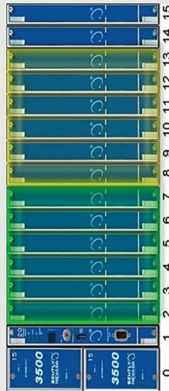
شبکه Ethernet جهت انتقال سیگنال‌های Dynamic و Static تنها به وسیله کارت مدل ۲۲M به SYSTEM1 Server پوشزد
