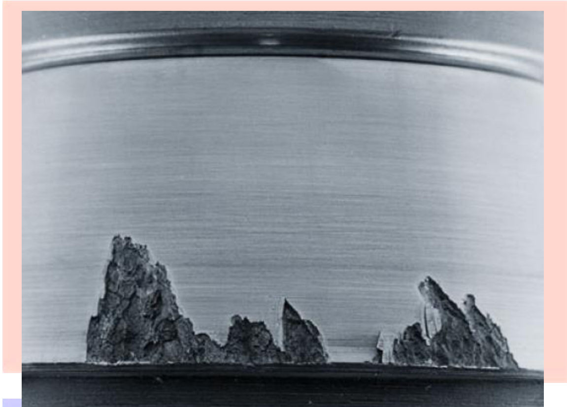
ورقه ورقه شدن ناشی از خستگی
